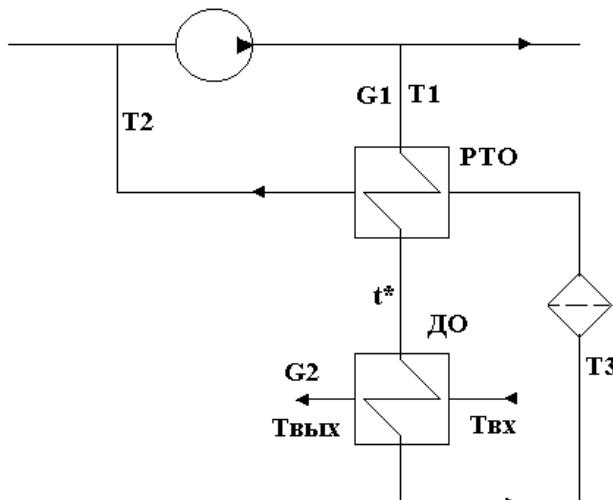
Для изображенной схемы байпасной очистки теплоносителя найти в общем случае значение температуры  $T_2$ , а также отношение расходов  $\frac{G_1}{G_2}$ , считая заданными величины  $G_1$ ,  $t_1$ ,  $t_3$ .
